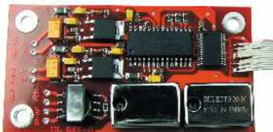
L'implantation de ce module répond initialement à deux objectifs : remplacer la puce d'origine, une **CS8420**, qui souffre d'un bug congénital empêchant l'échantillonnage 24/96kHz, et surtout accepter directement le flux numérique au format DTS.
